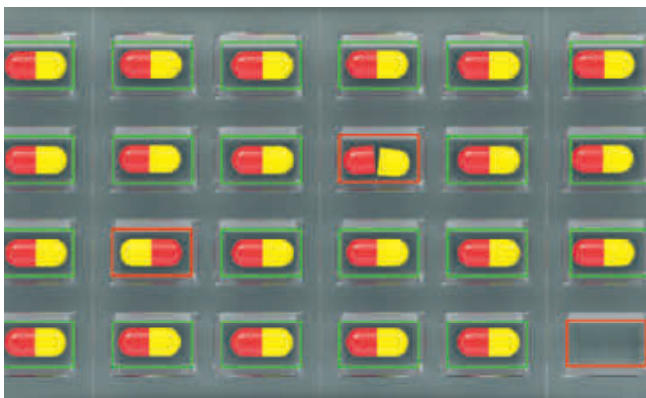
Inspection de plaquettes sous coques
